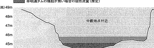
▲早明浦ダムの補給の有無による吉野川中藪地点付近の河川状況の変化(イメージ図)
